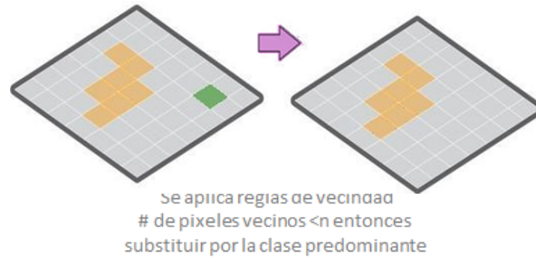
Figura 9 – Efecto de la aplicación del filtro espacial
