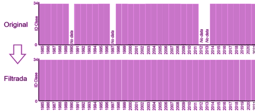
Figura 7 – Funcionalidad del filtro de Gap Fill
